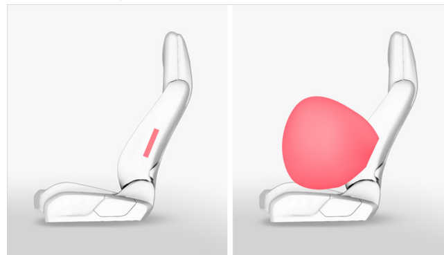
Расположение и область раскрытия боковых подушек безопасности
